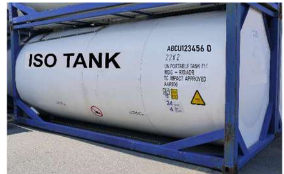
ISO タンクコンテナ 注)コンテナナンバーと外面表記の一部はダミーです。
