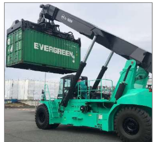
リーチスタッカー (弊社大阪港化学品センター)
