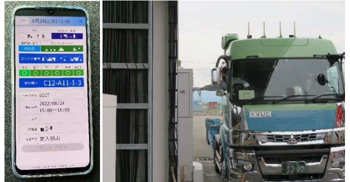
左) 運転手の持つ端末にコンテナ蔵置場所が表示される 右) PSカード（Port Security Card）を利用したゲート受付 （写真提供：阪神国際港湾株式会社）
