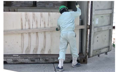
ラッシング作業(弊社 OCC)：合板と角材を用いて貨物をしっかり固定中。非木質のラッシング材でも作業品質は変わりません。
